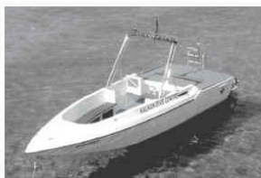
รูปแสดงรูปร่างของเรือที่เพรียวลมเพื่อลดแรงเสียดทาน
